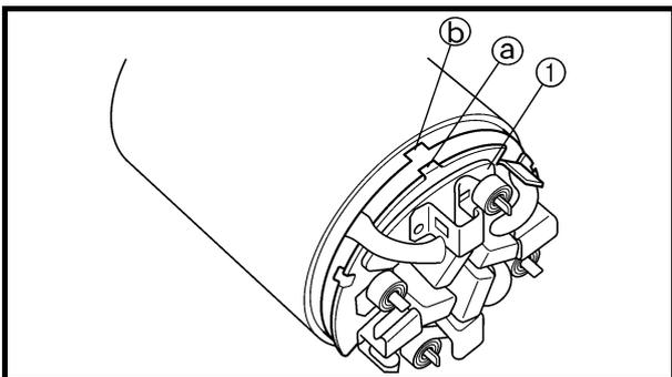
**ASSEMBLING THE STARTER MOTOR**
