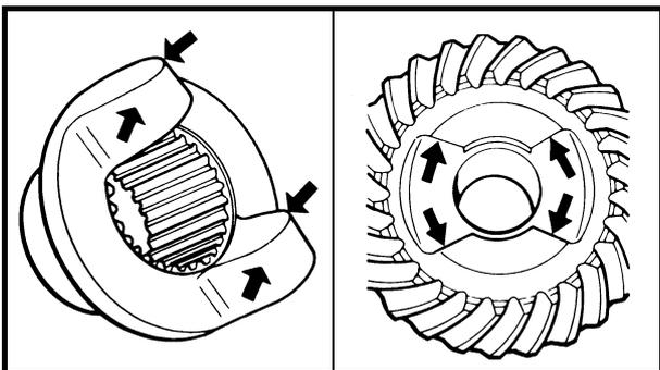
**CHECKING THE PINION GEARS**
