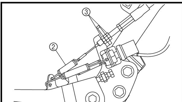
**ADJUSTING THE SELECT LEVER CONTROL CABLE AND SHIFT ROD/
