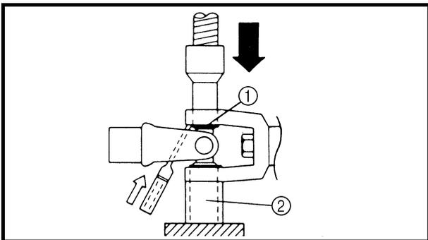
**REMOVING THE MIDDLE DRIVEN SHAFT**
