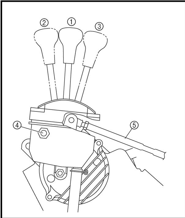
**ADJUSTING THE SELECT LEVER CONTROL CABLE AND SHIFT ROD**
