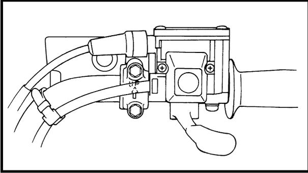
**INSTALLING THE MASTER CYLINDER ASSEMBLY**
