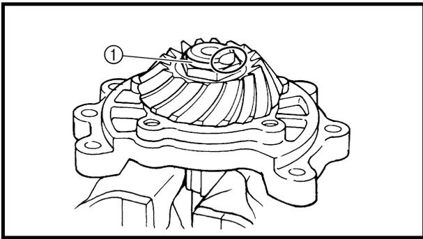
**REMOVING THE MIDDLE DRIVE SHAFT**
