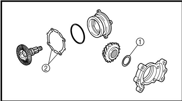
**SELECTING THE MIDDLE DRIVE AND DRIVEN GEAR SHIMS**
