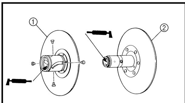
**ASSEMBLING THE SECONDARY SHEAVE**
