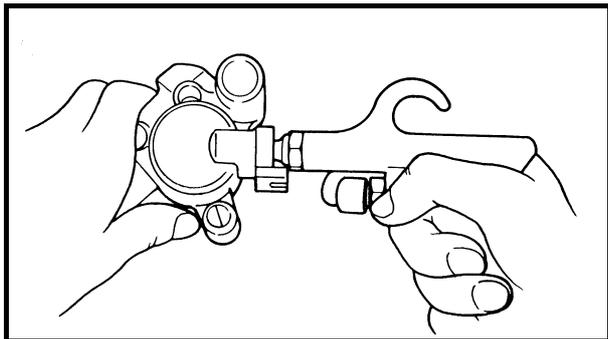
**DISASSEMBLING THE FRONT BRAKE CALIPERS**
