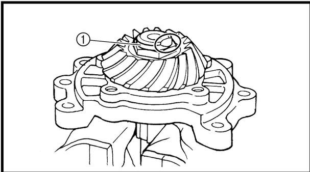
**INSTALLING THE MIDDLE DRIVE SHAFT**
