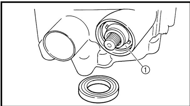
**INSTALLING THE MIDDLE DRIVEN SHAFT**
