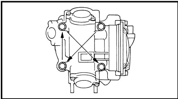
**INSTALLING THE CYLINDER HEAD**
