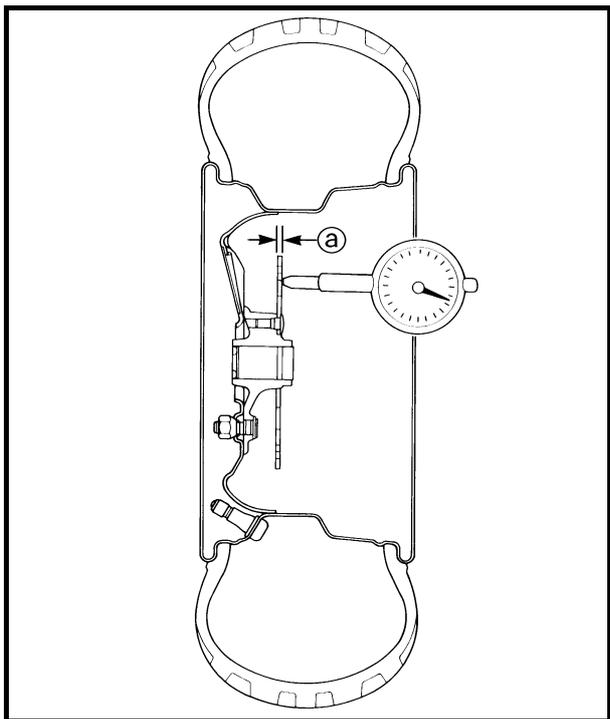
**CHECKING THE BRAKE DISCS**
