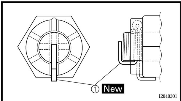
**INSTALLING THE WHEEL HUBS**
